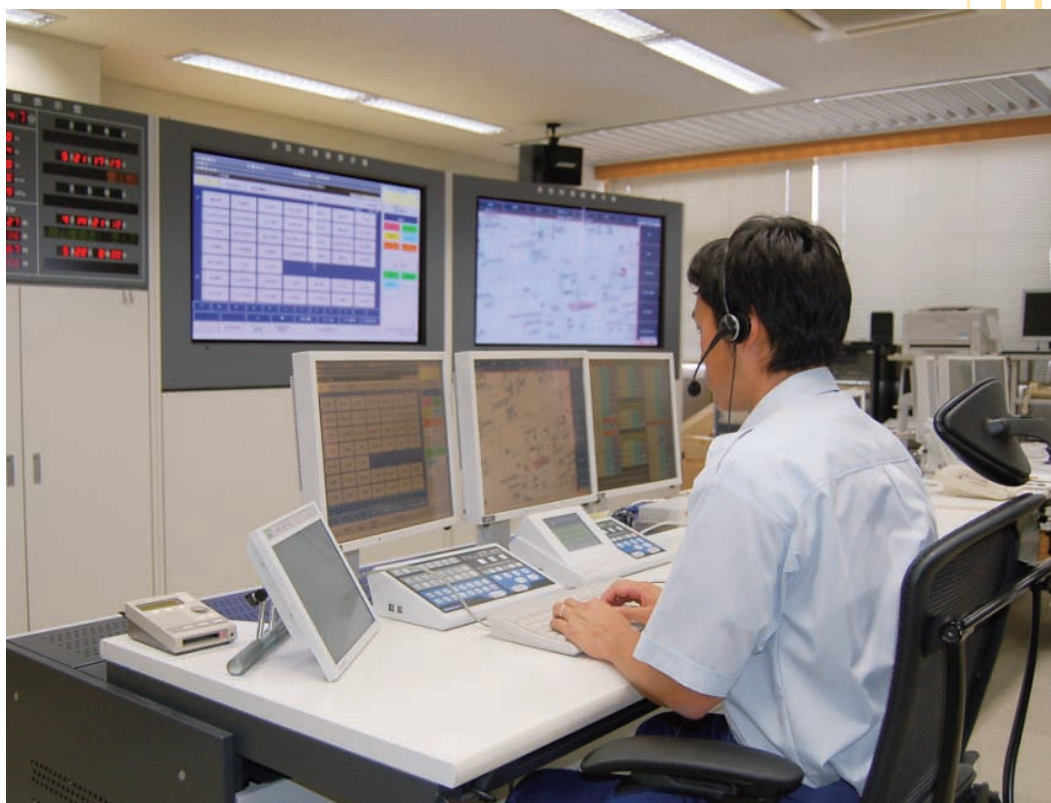
消防緊急通信指令システム
